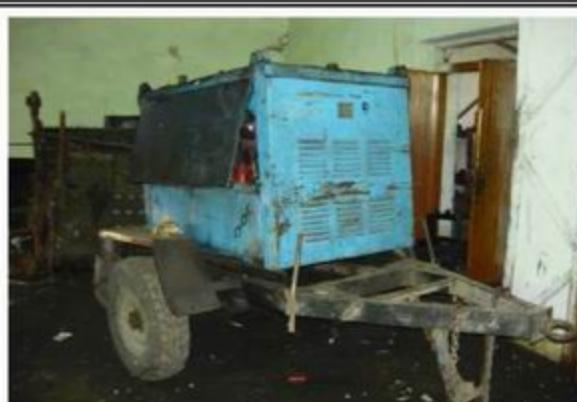
51. Сварочный агрегат передвижной АДЛ-4004
