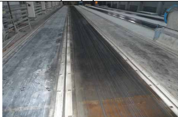
2.2 Металлопокрытие с фаскообразователями и фиксаторами.
