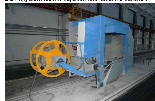
2.2 Гидравлический барабан для кабеля с кабелем
