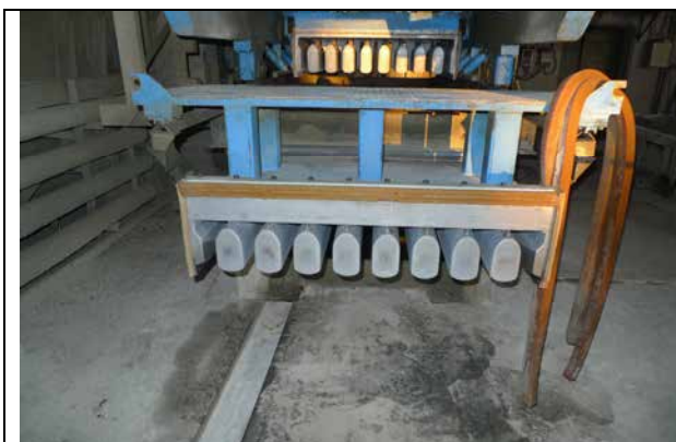
2. Машина для резки плит.
