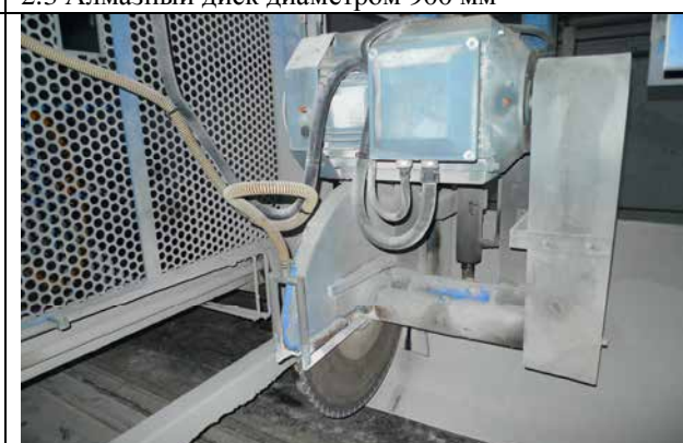
2.3 Алмазный диск диаметром 900 мм
