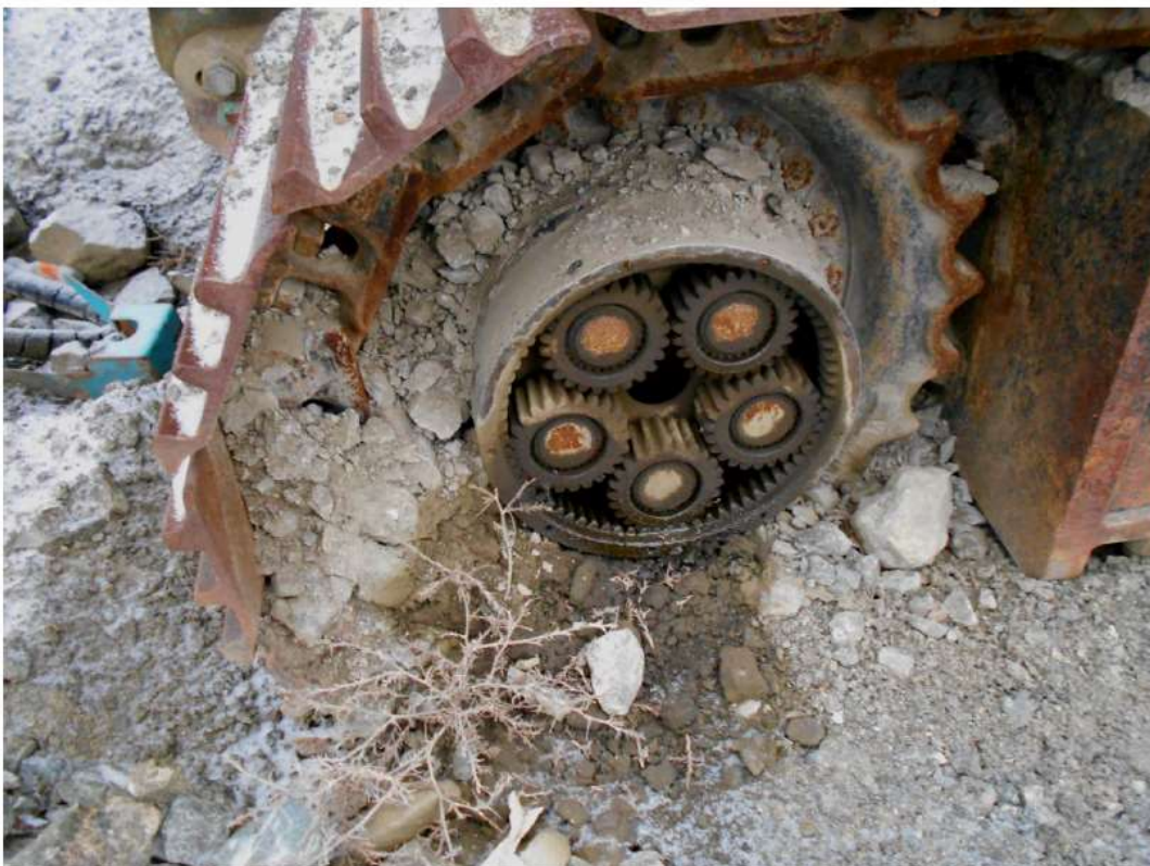
На щековой дробилке POWERSCREEN ХА400S демонтированы и отсутствуют детали на гусеничном приводе.
