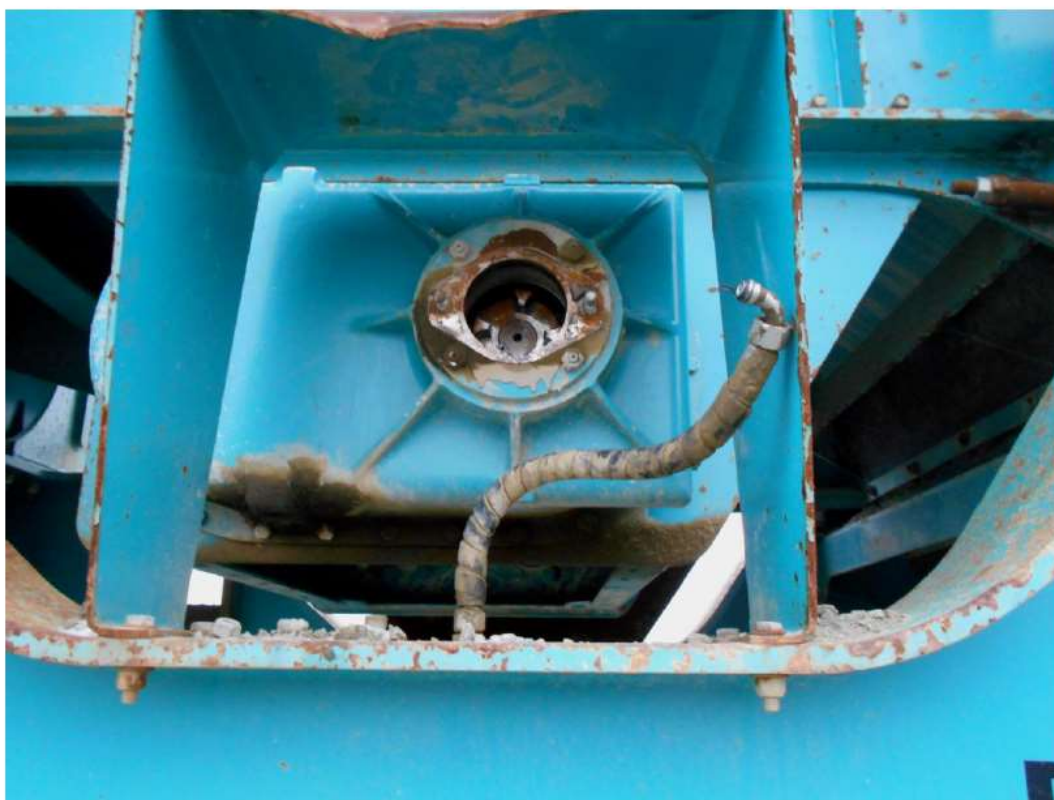
На щековой дробилке POWERSCREEN ХА400S демонтированы и отсутствуют ящик пульта управления и выносной пульт управления.
