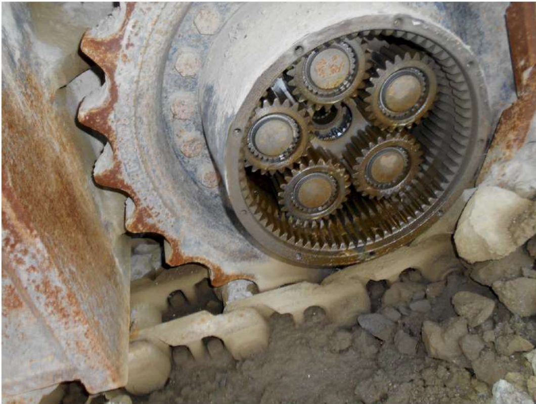
На щековой дробилке POWERSCREEN ХА400S демонтированы и отсутствуют детали на гусеничном приводе.
