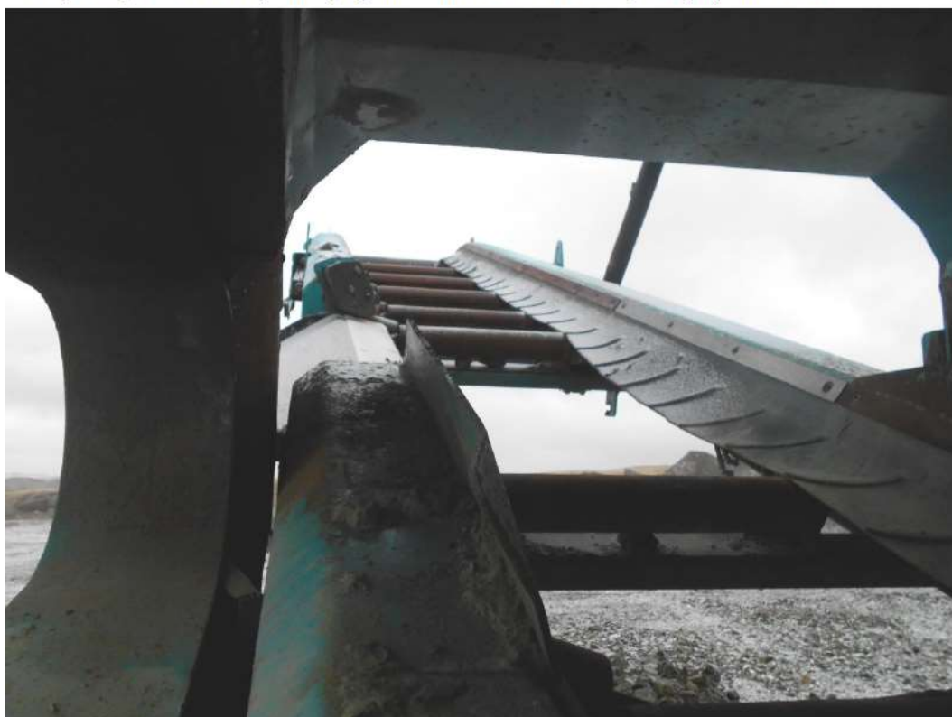
На щековой дробилке POWERSCREEN ХА400S демонтирована и отсутствует лента главного (производственного) конвейера.
