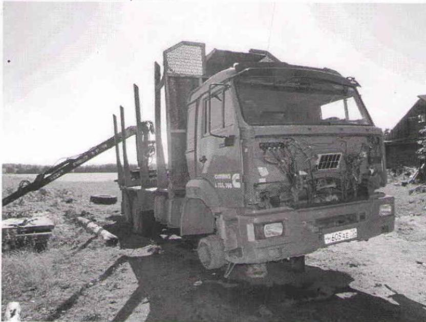
Во время осмотра выявлено: отсутствие передних колес, крышки капота, головки гидроманипулятора, трещина рамы (со слов Лазарева В.В. при погрузке автомобиль перевернулся, в результате произошла деформация рамы), двигатель автомобиля не запускали – севшие аккумуляторы (со слов Лазарева В.В. двигатель исправен, неисправна коробка передач).
