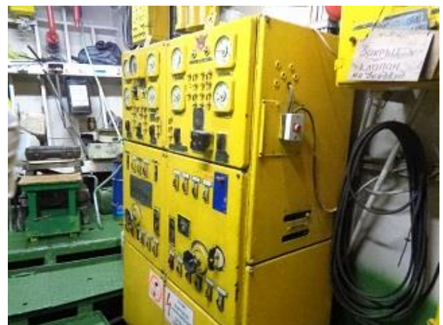
Морской буксир «Хасанец». Механизмы и оборудование машинного отделения. Главные двигатели. Главный распределительный щит
