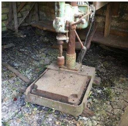
**Фото 124 5290\_насто́льно-сверлильный станок**
