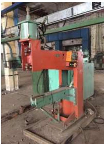
**Фото 203 6513\_АППАРАТ ТОЧЕЧНОЙ СВАРКИ МТ-1222 (Лаборатория) (2)**
