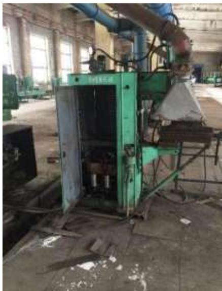
**Фото 43 4148\_МАШ.Д ЭЛ.КОНТ-ТОЧЕЧНОЙ СВАР.МТП-2007 3**
