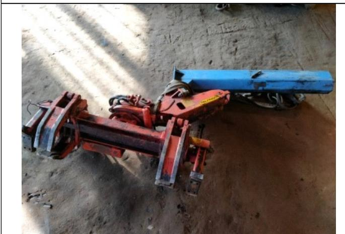
**Фото 31. Захват трубный для гидроманипулятора PALFINGER PZM**
