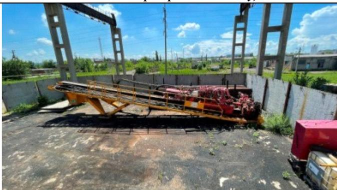
**Фото 3. Установка ГНБ Herrenknecht HK250T, заводской номер W09003232 E0Z04172 (включая гидроагрегат и кабину).**
