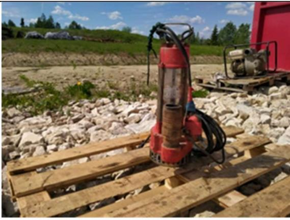
**Фото 33. Насос погружной дренажный Quattro Elementi Sewage 1500F CI для грязной воды, Серийный номер: 1216TY17425**
