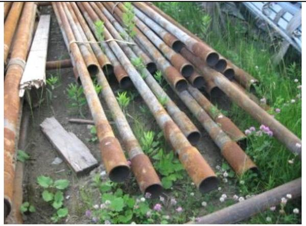
**Фото 40. Труба буровая, диаметром 73 мм**
