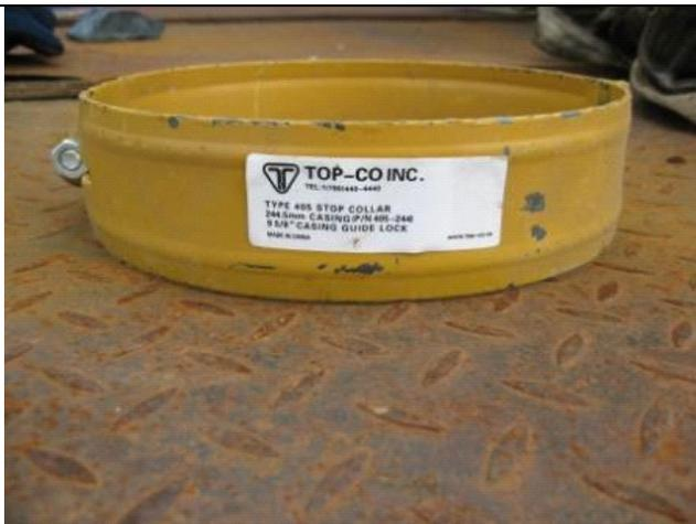
**Фото 43. Стопорное кольцо с болтом - стяжкой для ОК 244,48 мм. TOP-CO Inc. (Канада) Type 405 Stop Collar, пр-во Китай**
