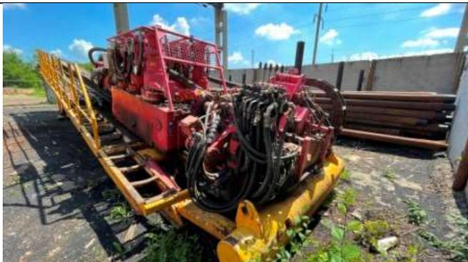
**Фото 1. Установка ГНБ Herrenknecht HK250T, заводской номер W09003232 E0Z04172 (включая гидроагрегат и кабину).**
