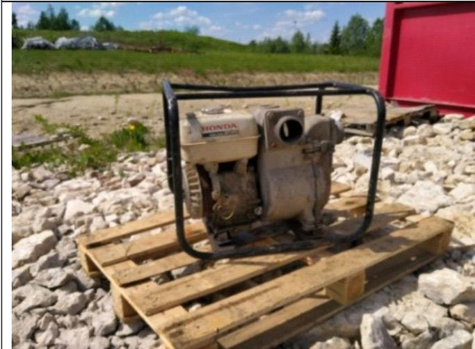
**Фото 21. Мотопомпа HONDA TRASH PUMP WT30X**
