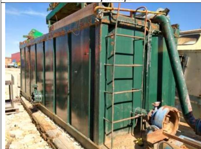
*Фото 47. Система подготовки и подачи бурового раствора*
