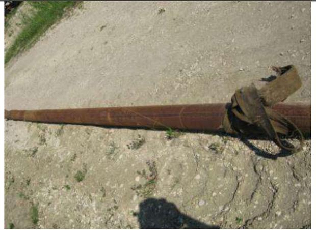
**Фото 40. Винтовой забойный двигатель ВЗД 3ЛЗ
