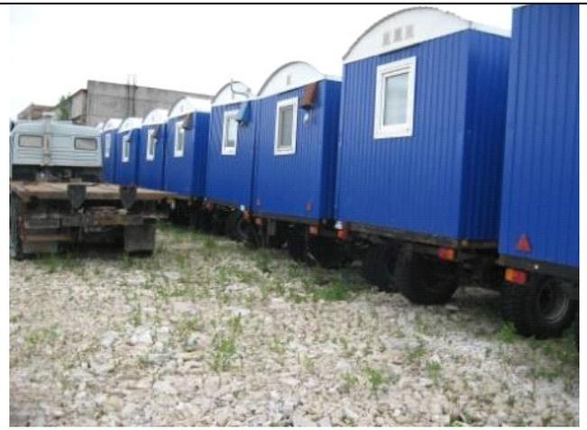
**Фото 62. Здания мобильные «Башкирия» на тракторном прицепе-площадке**
