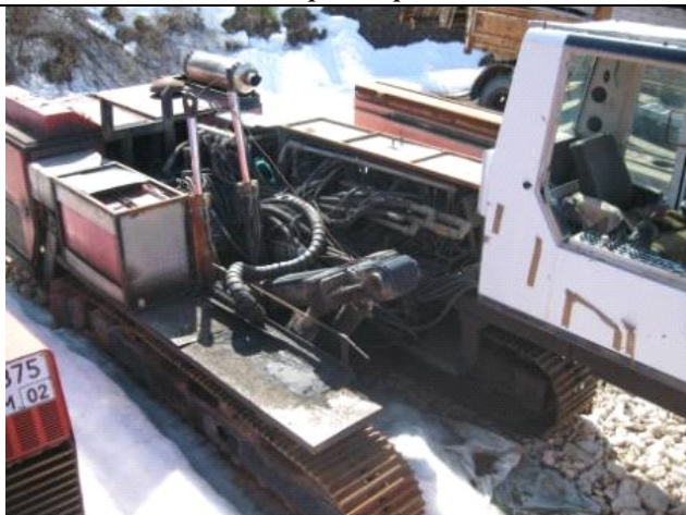
Фото 23. Самоходная буровая установка PRIME DRILLING PD 150/50 RP- K; з. н. 02 MB 0018, VIN: 03105
