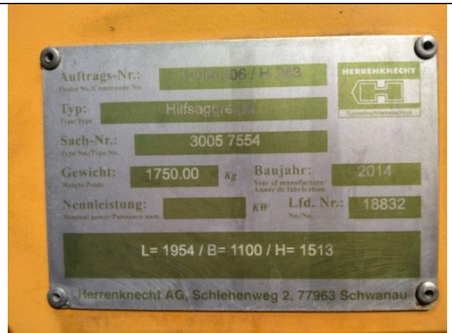
Фото 20. Силовая установка HERRENKNECHT Hitsaggregat 12000306/H- 243, пр-во Германия, №3005 7554
