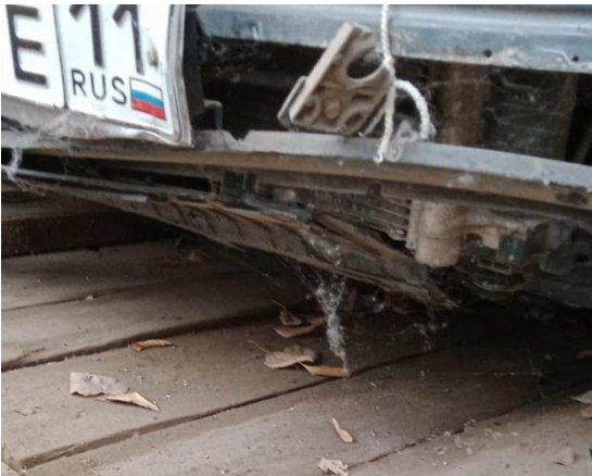
Повреждения нижней фронтальной части ТС
