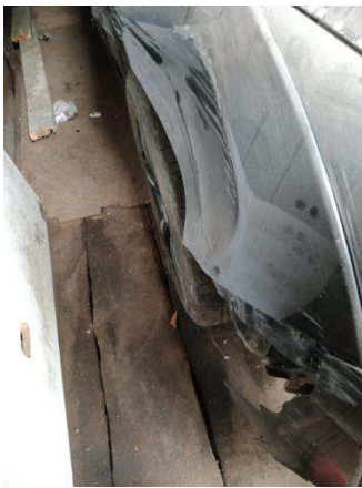
Повреждения крыла переднего правого
