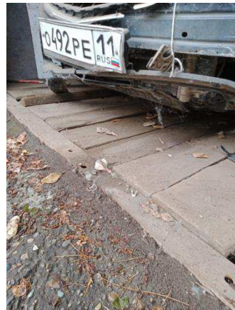
Повреждения нижней фронтальной части ТС
