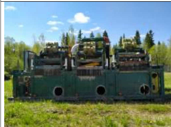
Фото 3. Установка для ОБР Kemtron «TANGO 1000S», пр-во США
