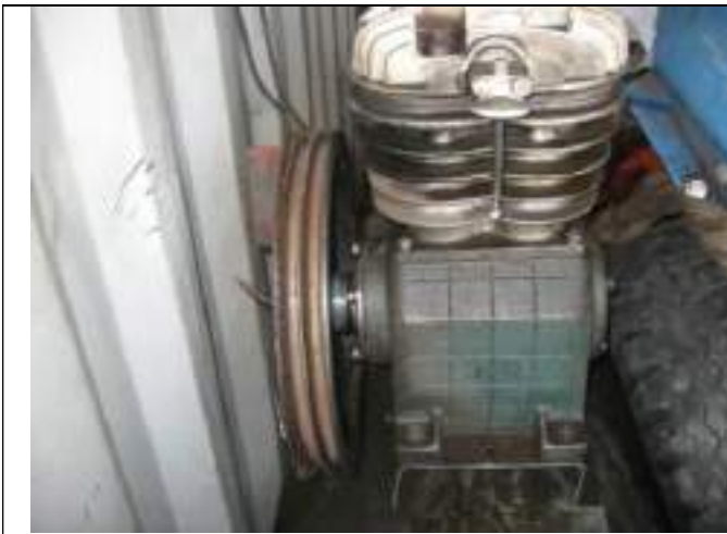
Фото 25. Компрессорная установка К-20
