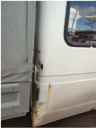
Повреждения правой панели боковины
