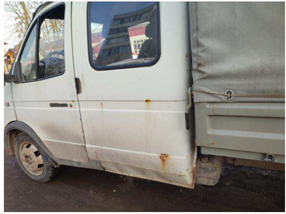
Повреждения левой панели боковины
