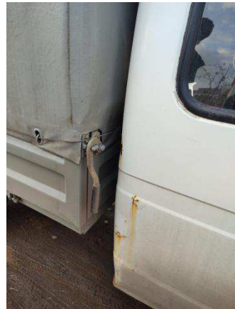
Повреждения правой панели боковины
