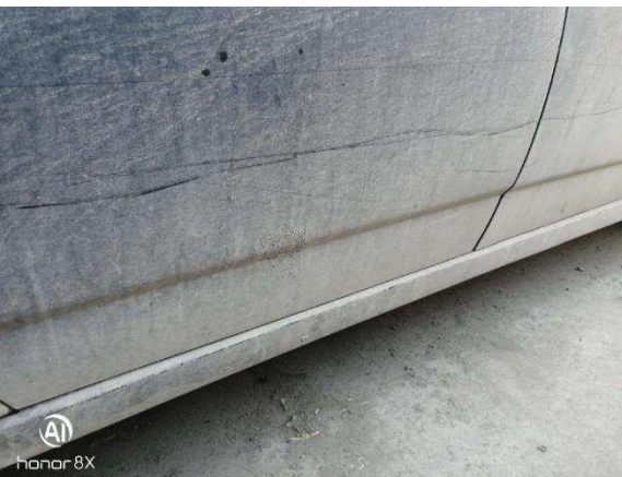
Нарушение ЛКП двери задней правой
