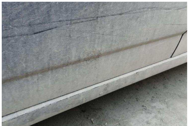
Нарушение ЛКП двери задней правой
