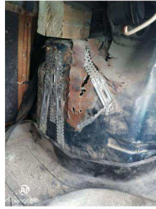
Коррозия арки заднего правого колеса
