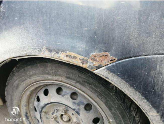
Коррозия крыла заднего левого
