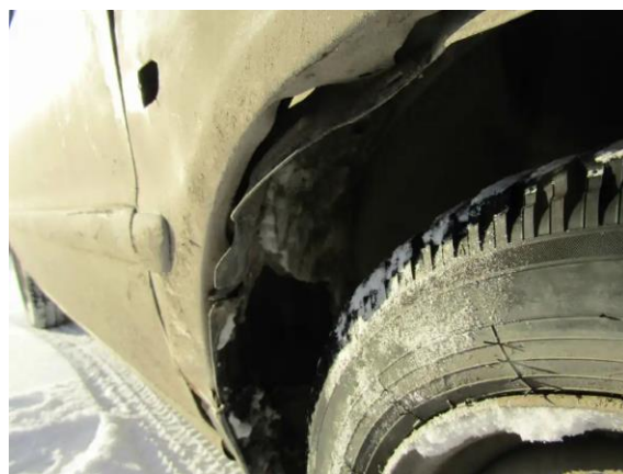
Фото №81. Дефекты эксплуатации
