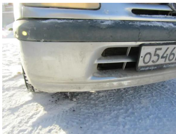
Фото №71. Дефекты эксплуатации
