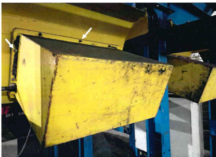
Фото 4. Питатель вибрационный. Отсутствует до 50% болтов и гаек крепления кожуха.
