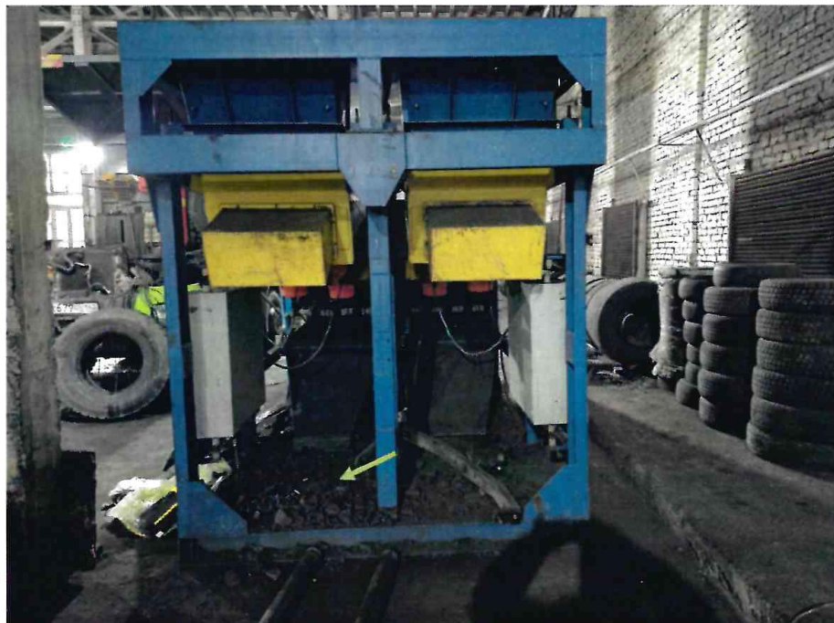
Фото 2. Наличие сепарируемой породы и угля на конструкциях сепаратора.
