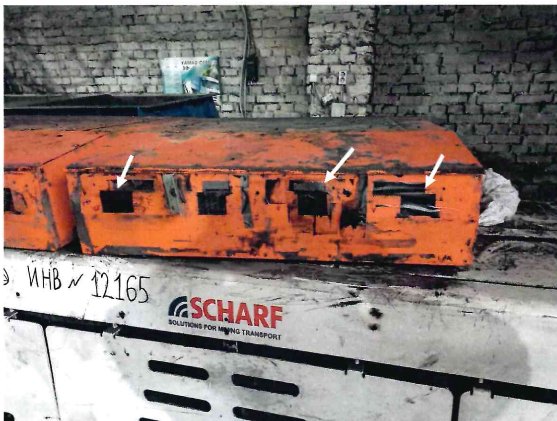
Фото 7. Рентгеновская установка (демонтирована). Защитные экраны окошек излучателей частично отсутствуют, частично имеют повреждения.
