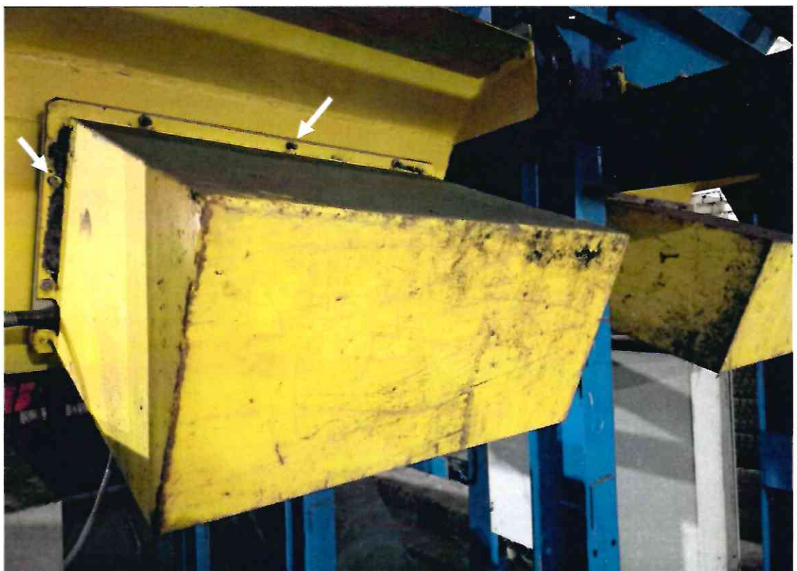
Фото 4. Питатель вибрационный. Отсутствует до 50% болтов и гаек крепления кожуха.
