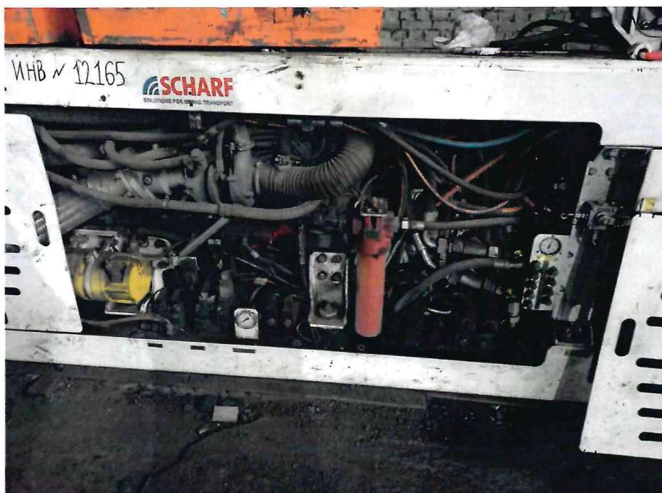
Фото 6. Дизельная секция (защитные экраны сняты)
