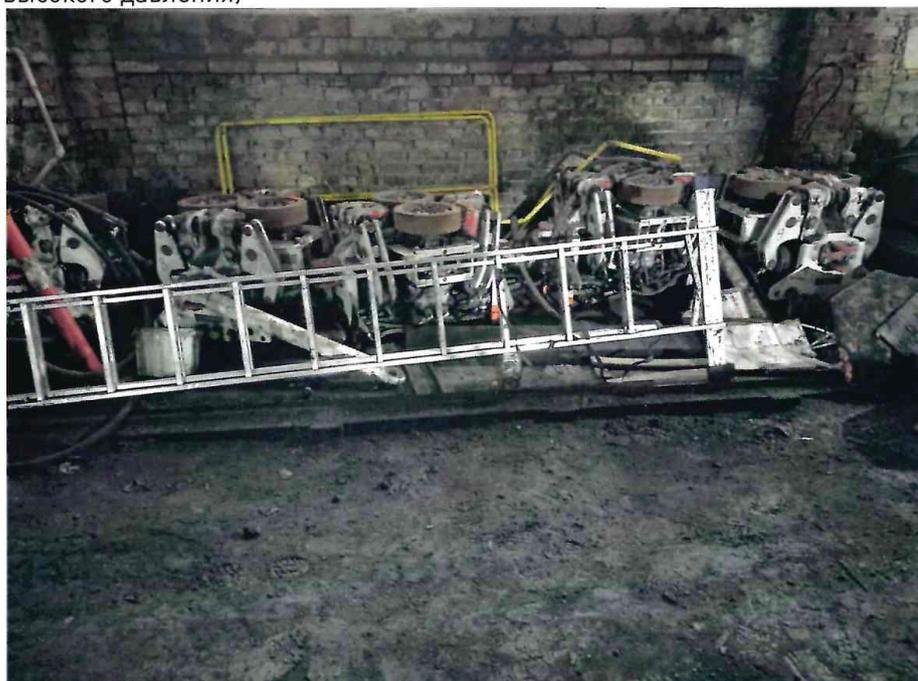
Фото 2. Приводные механизмы и соединительные штанги
