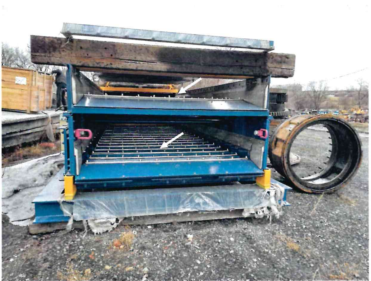
Фото 4. Отсутствуют полиуретановые сита на обеих деках
