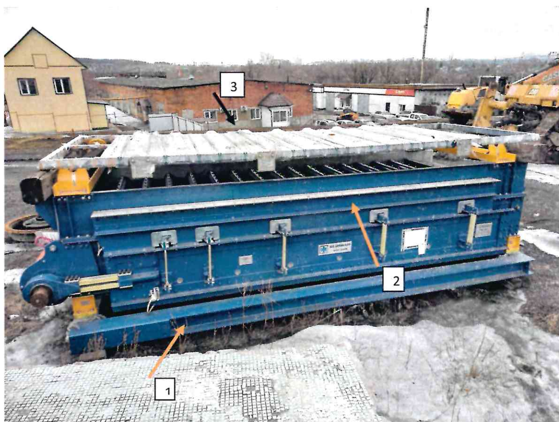
Фото 1. Общий вид грохота LIWELL LF 2.0-5.04/16DD-big: 1 – опорная рама грохота, 2 - двухдековая платформа, 3 - укрытие грохота (в упаковке).
