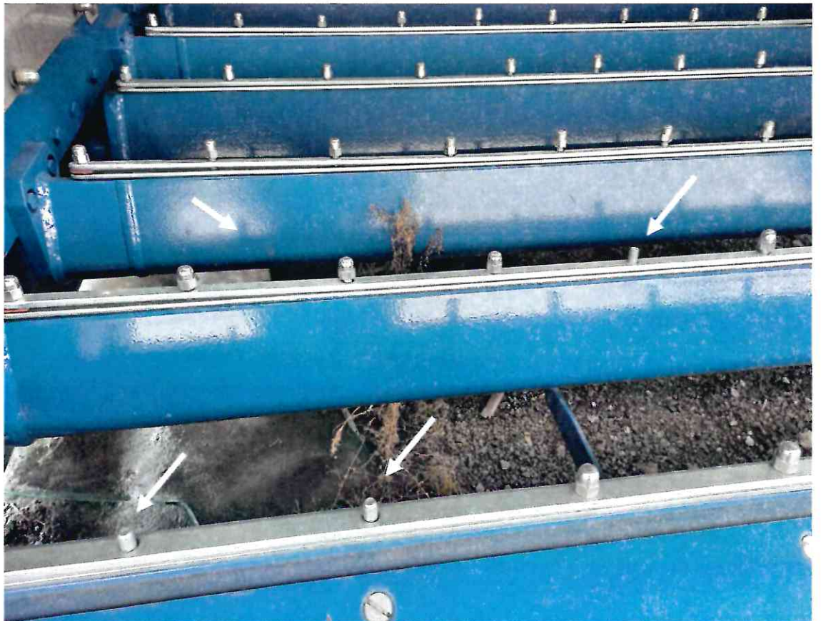
Фото 3. Отсутствуют полиуретановые сита на обеих деках и часть крепежа сит.
