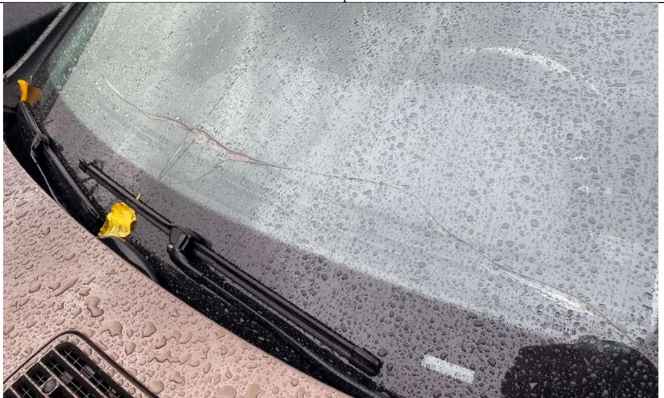
Фото 8. Трещина на лобовом стекле
