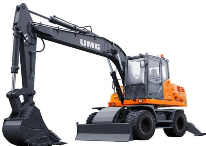
Экскаваторы колесные – это землеройные машины, предназначенные для раскопки, транспортировки и погрузки грунта на различных объектах строительства. Колесные экскаваторы имеют специальное шасси, оснащенное пневматическим приводом. Кроме того, пневмоколесная техника имеет выносные опоры, которые обеспечивают устойчивость и исключают сползание в процессе загрузки ковша.
