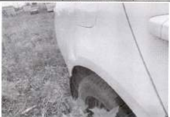
Крыло заднее, вмятина, следы ремонта
