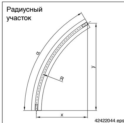
По своей конструкции рад. участки соответст. прямолинейным. Радиус. участки КВК II-R всегда оснащаются 5ти-пол. шинопроводом. В установках на профиле КВК II-R4 шина управления не используется. Для установок на проф. КВК II-L применяются рад. участки КВК II. Для этого требуется переходное болтовое соединение, см. раздел 4.2. Детали системы КВК II-R см. в брошюре № 222 181 44.
