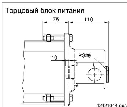
Торц. блок питания служит для подачи тока через конец профиля КВК II-R. Он состоит из крышки с буфером и клеммной коробки с заглушкой Pg 29 (макс. поперечн. сеч. соединения 10 мм<sup>2</sup>, гибкое соединение). Торц. блок питания подсобран, прилагаются штекерные соединители с соедин. проводками. Торцовый блок питания без защитной проводки по заданию.
